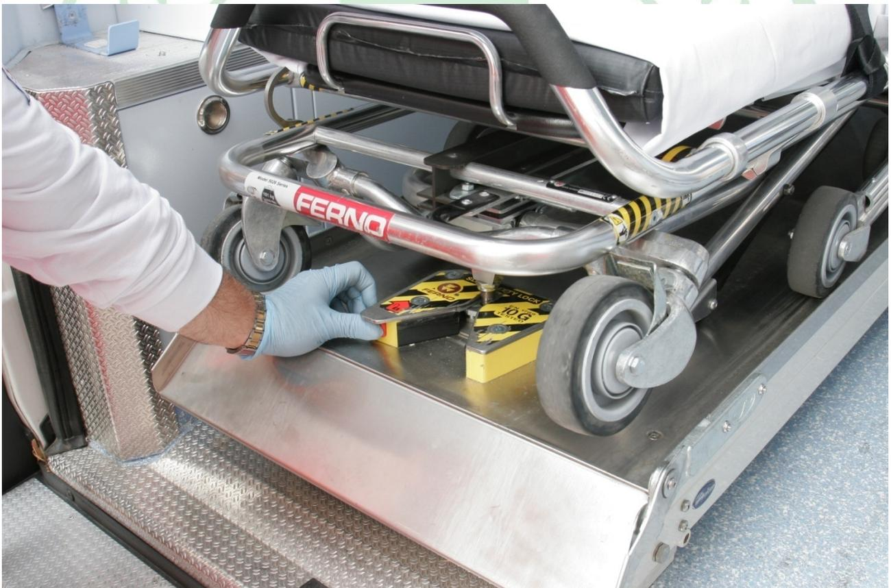
La barella autocaricante è dotata di un carrello che permette di trasportarla senza doverla sollevare. Diversi sono i modelli delle barelle autocaricanti ma comune è il principio del loro utilizzo e dei metodi di bloccaggio e sbloccaggio.
